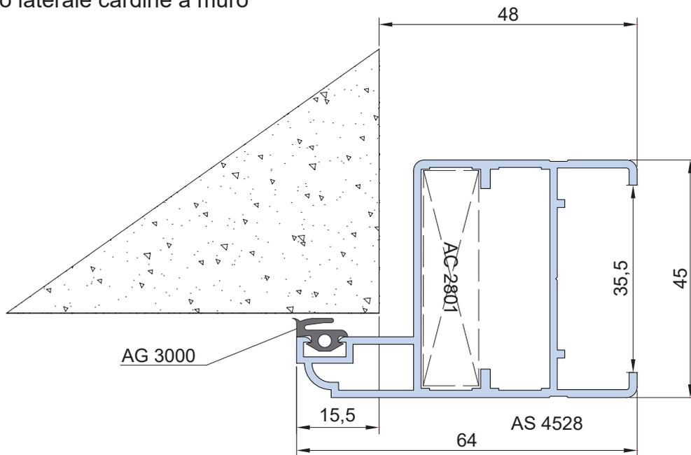
Nodo laterale con telaio battuta 10mm
