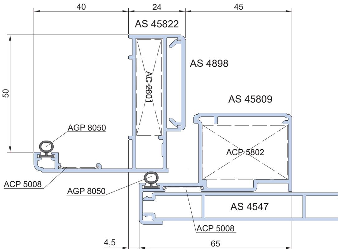
Nodo laterale con telaio battuta 70mm
