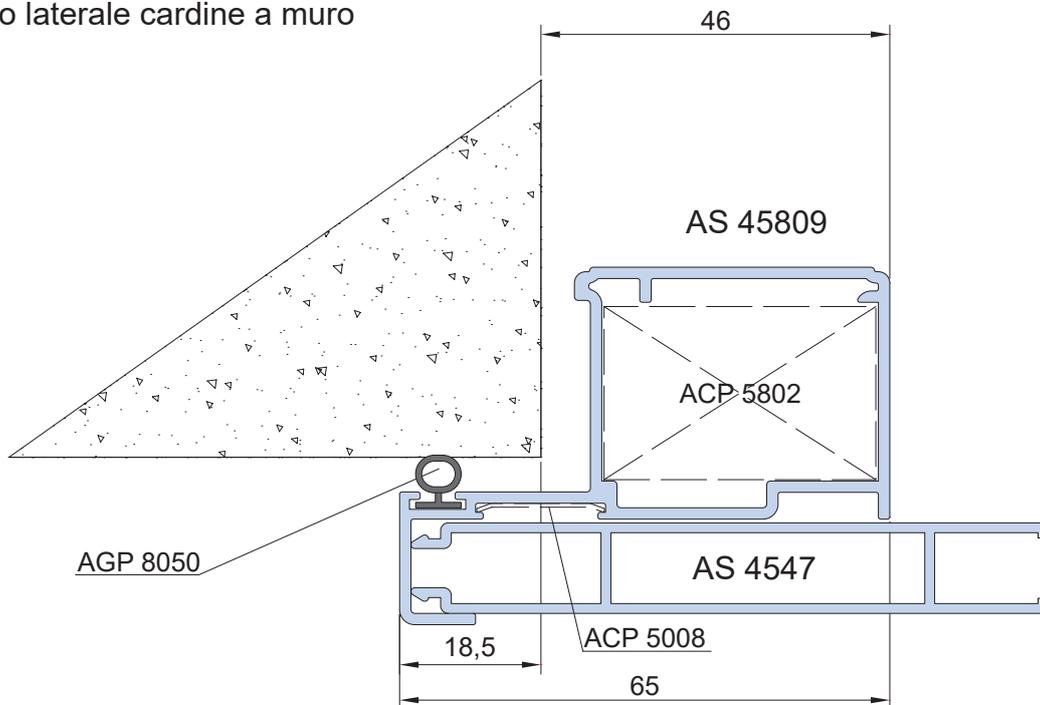
Nodo laterale con telaio battuta 10mm
