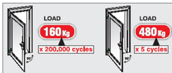
Esempio di test ciclico con carico nominale a 160kg
