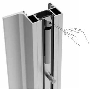
Stringere il grano del terminale di posizionamento quando si è raggiunta l'altezza corretta Tight the rod when reached the correct position
