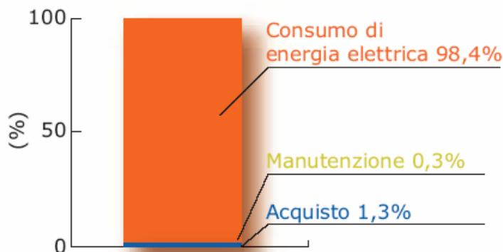
Fig. 2 – Costi di acquisto e di esercizio di un motore elettrico
