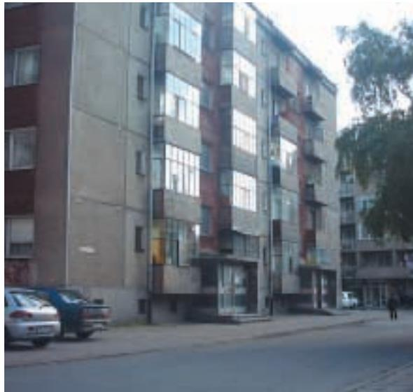
Fig. 2.9 - Un tipico esempio di edilizia con pannelli prefabbricati.
