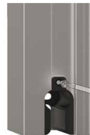
dopo aver inserito il tappo nel profilo, fissarlo al montante verticale con una vite TPS 3,9x13
