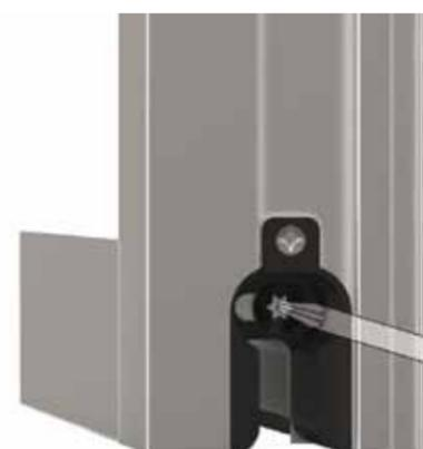
fissare il montante verticale con lo zoccolo (dopo averlo intestato) tramite una vite TC 4,8x25, passante sotto il tappo
