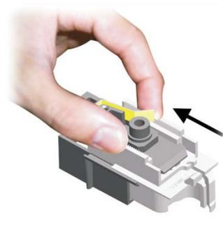
**ATTENZIONE:** nel caso in cui fosse necessario riportare la compensazione telescopica superiore con molla a nastro nella posizione di partenza indicata col segno "0" bisogna stringere con le dita l'estremità della molla e contemporaneamente far traslare i due corpi compensatori (vedi figura sopra).
