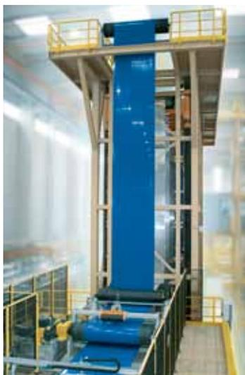
L' alluminio arriva dal laminatoio sotto forma di bobine (coil). La bobina viene posizionata all'inizio della linea di verniciatura, e viene poi srotolata a velocità costante, passando attraverso un pretrattamento, vari bagni di verniciatura e forni di vulcanizzazione, prima di essere riavvolta.
