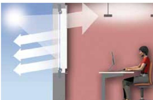
Questa peculiare caratteristica rende l'alluminio un materiale molto efficiente per la gestione della luce. È possibile infatti, tramite collettori di raggi solari e canali luminosi in alluminio, ridurre il consumo di energia per l'illuminazione ed il riscaldamento in inverno. Per ridurre l'impiego di aria condizionata in estate, è inoltre possibile utilizzare dispositivi di schermatura in alluminio.
