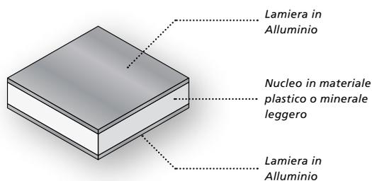
ad esempio i pannelli a sandwich costituiti da due lamiere di alluminio fissate ad uno strato di polietilene. Facili da piegare e da curvare, questi prodotti possono essere impiegati per realizzare rivestimenti, coperture, articoli da esposizione ed applicazioni caratterizzanti della corporate identity .
