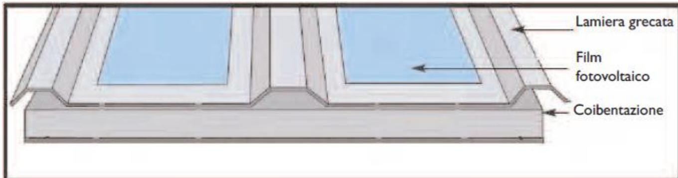
**Modulo fotovoltaico non convenzionale consistente in strato metallico e film fotovoltaico**
