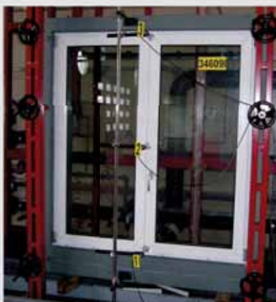
Campione sottoposto a prova durante i test di resistenza al vento (prova di deformazione)
