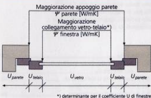
Figura 10 Componenti della finestra
