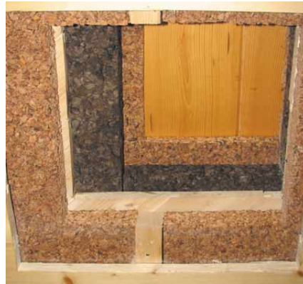
isolamento con pannelli di sughero
