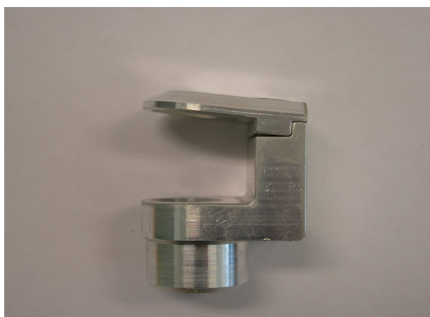
Figura 21. Sostegno ad una via deformato dalla prova a trazione.
