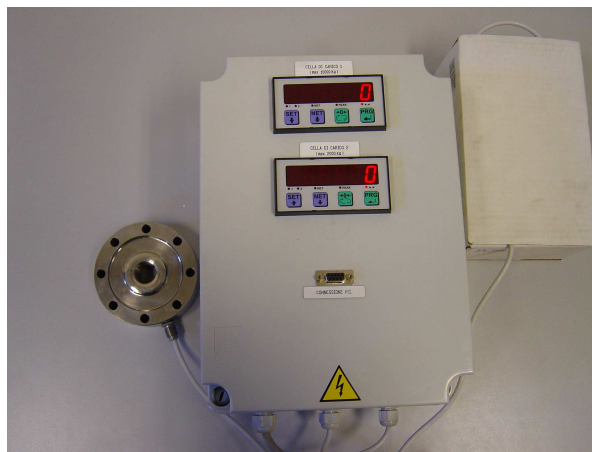
Figura 7. Cella di carico e lettore digitale
