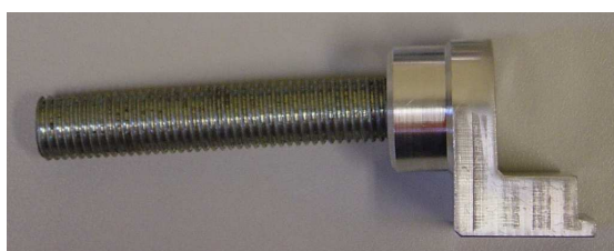
Figura 25. Sostegno a una via deformato dalla prova a taglio.
