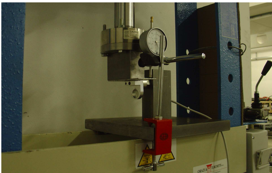
Figura 12. Prova a taglio: supporto a due vie.
