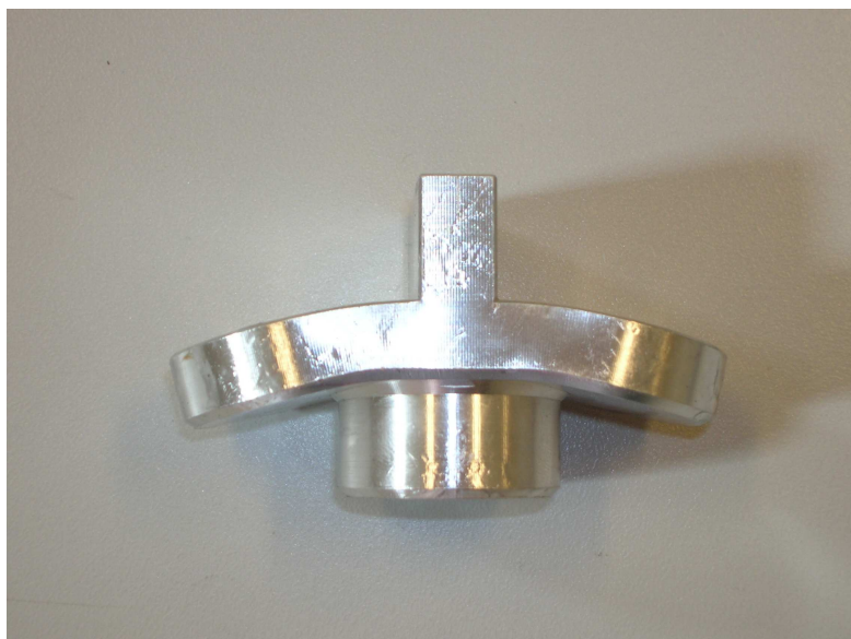
Figura 16. Sostegno a due vie sottoposto alla prova a flessione su basi a due vie.
